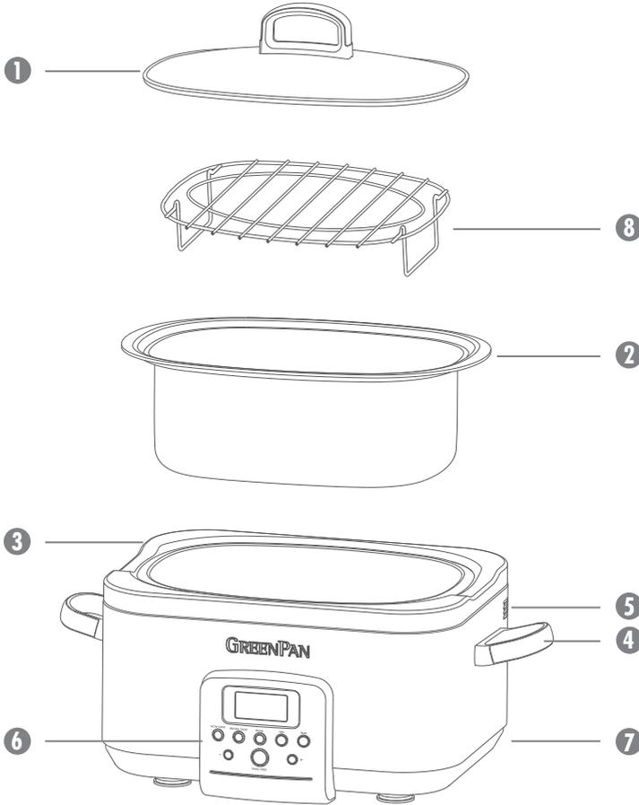
1. Deckel aus gehärtetem Glas
